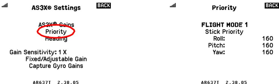
Le paramètre Priorité contrôle l'équilibre entre l'entrée du manche et la réaction automatique de l'AS3X. Le paramètre par défaut est de 160 % pour tous les axes, ce qui semble être un bon point de départ pour la plupart des modèles.
