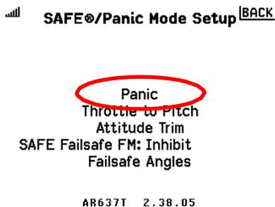
Les réglages de la section 2 ont assigné le canal de contrôle de panique à Aux 1. J'ai également ajusté les limites de l'enveloppe pour qu'elles soient beaucoup plus strictes, en particulier pour le pitch (nez) vers le bas. Vous devez également sélectionner un mode de vol que Panic doit utiliser pour les paramètres de gain. Sélectionnez le mode de vol pour lequel la mise à niveau automatique est activée.
